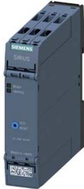
Relé de protección de motor por termistor Aparato de evaluación estándar Caja de 22,5 mm borne de tornillo 2 conmutados US = AC/DC 24 V-240 V REARME Manual/Auto/Remoto con homologación ATEX 2 LED (READY/TRIPPED) aislamiento galvánico seguro Pulsador de prueba/REARME vigilancia de rotura de hilo vigilancia de cortocircuito no volátil
