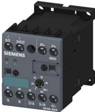
relé temporizador, electrónico multifunción, 16 funciones 2 conmutados AC/DC 24 hasta 240 V con AC 50/60 Hz 0,05 s hasta 100 h 45 mm de ancho borne de tornillo
