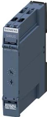
relé temporizador, electrónico retardado a la excitación 1 NA (semiconductor) 2 hilos 4 rangos de tiempo 0,05...240 s AC/DC 12-240 V borne de tornillo
