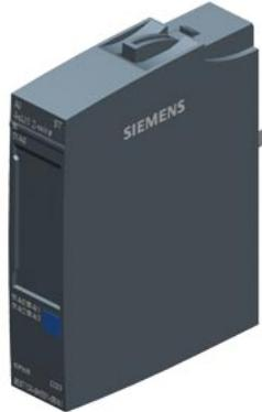
SIMATIC ET 200SP, módulo de entradas analógicas, AI 4XU/I 2 hilos Standard, 1 unid. por paquete, código de color CC00, código color CC03, diag. módulo, 16bit, +/-0,3%,
