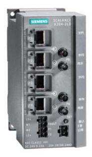
SCALANCE X204-2LD, managed IE Switch, 4x 10/100 Mbits/s puertos RJ45, 2x 100 Mbits/s BFOC monomodo, Contacto de señalización de fallo con pulsador SET, parada, alimentación redundante, Dispositivo PROFINET IO, gestión de red, administrador de redundancia integrado, incl. manual electrónico en CD-ROM, C-PLUG opcional
