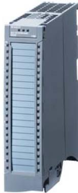
SIMATIC S7-1500, módulo de salidas analógicas AQ 4xU/I ST, resolución de 16 bits, precisión 0,3 %. 4 canales en grupos de 4, diagnóstico; valor sustitutivo; el módulo admite la desconexión de seguridad de grupos de carga hasta SILCL1 según EN 62061:2005 + A2:2015, y Cat. 2 / PL c según EN ISO 13849-1:2015 el suministro incluye elemento de alimentación, estribo de pantalla y borne de conexión de pantalla: conector frontal (bornes de tornillo o de inserción rápida) pedir por separado
