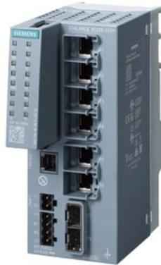
SCALANCE XC206-2SFP switch IE gestionable capa 2; con certificación IEC 62443-4-2; 6 puertos RJ45 10/100 Mbits/s; 2 puertos SFP 100/1000 Mbits/s; 1 puerto de consola; LED de diagnóstico; alimentación redundante; rango de temperaturas de -40 °C a +70 °C; montaje: perfil DIN/soporte S7/pared funciones de redundancia Office Features (RSTP, VLAN, ...); dispositivo PROFINET IO; conforme con Ethernet/IP; ranura para C-PLUG;
