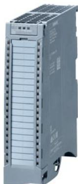
SIMATIC S7-1500, módulo de entradas analógicas AI 8 x U/R/RTD/TC HF, Resolución de 16 bits, hasta 21 bits de resolución con RTD y TC, precisión 0,1 %, 8 canales en grupos de 1, tensión en modo común: 30 V AC/60 V DC, diagnóstico; alarmas de proceso rango de medida de temperatura escalable, termopar tipo C, calibración en RUN. El suministro incluye elemento de alimentación, abrazadera de pantalla y clip de pantalla: conector frontal (bornes de tornillo o de inserción rápida) pedir por separado
