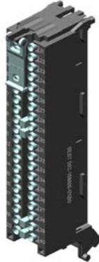
SIMATIC S7-1500, conector frontal con bornes de inserción rápida, 40 polos, para módulos de 35 mm de ancho incl. 4 puentes de potencial y brida
