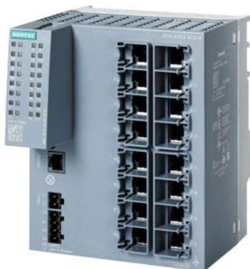
SCALANCE XC216 switch IE gestionable capa 2; con certificación IEC 62443-4-2; 16 puertos RJ45 10/100 Mbits/s; 1 puerto de consola; LED de diagnóstico; alimentación redundante; rango de temperaturas de  $-40\text{ }^{\circ}\text{C}$  a  $+70\text{ }^{\circ}\text{C}$ ; montaje: perfil DIN/soporte S7/pared funciones de redundancia Office Features (RSTP, VLAN, ...); dispositivo PROFINET IO; conforme con Ethernet/IP; ranura para C-PLUG;
