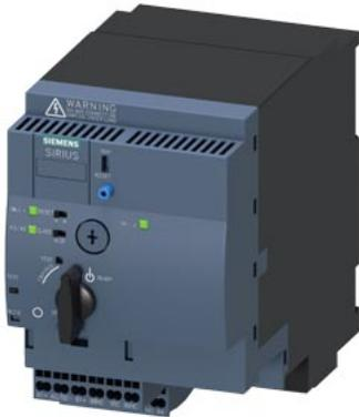
SIRIUS derivación compacta arrancador inversor 690 V AC/DC 24 V 50...60 Hz 1...4 A IP20 Conexión del circuito principal: enchufable, sin bornes Conexión circuito de mando: borne de resorte
