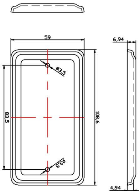
Para cubrir el cableado eléctrico en cajas rectangulares
