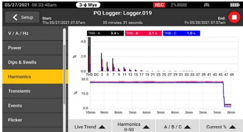
Cada armónico se puede seleccionar fácilmente para ver los datos de tendencia a medida que cambian las cargas
